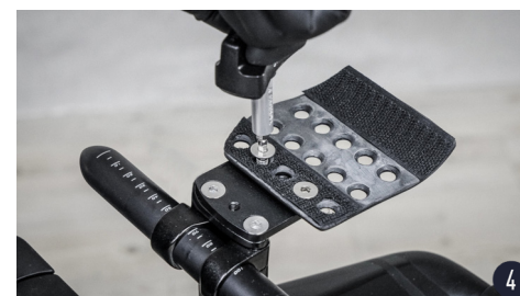
將手肘靠墊延伸座用短平錐螺絲，選擇左右兩邊對稱的位置，以 5Nm 鎖上。
