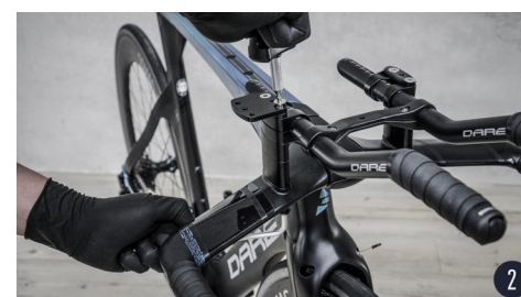
鬆開螺柱，取下手肘靠墊座 [D7, D8]，調整位置裝上延伸片（字母朝下，R 組裝在右方，L 組裝在左方），重新將螺絲穿過鎖上。
