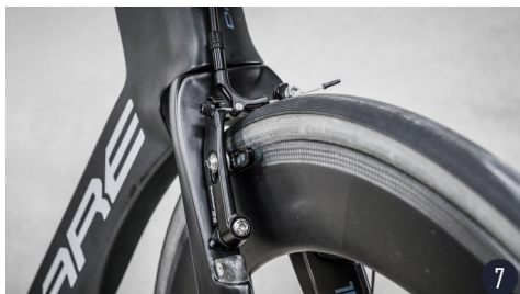
依 P.13 煞車寬度調整教學頁檢查並調整煞車夾器。
