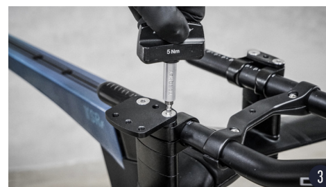
拿 5 號六角板手及 4 號扭力板手將左右延伸片四個螺絲以 5NM 鎖緊。
